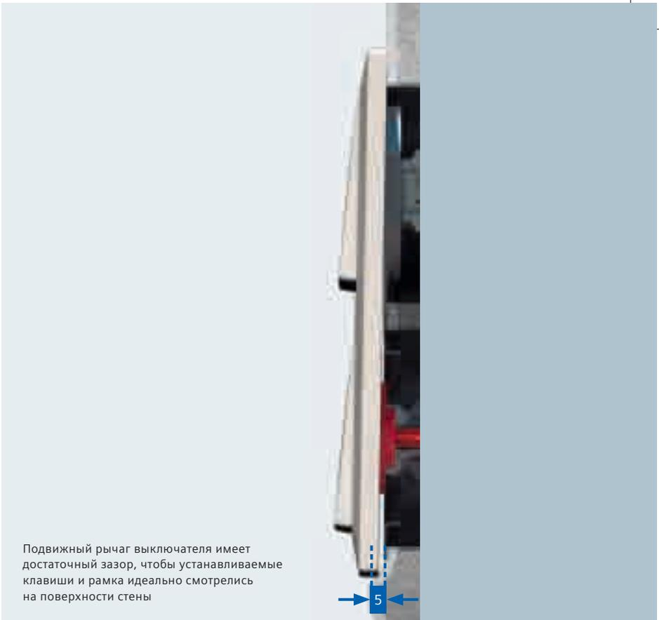
Подвижный рычаг выключателя имеет достаточный зазор, чтобы устанавливаемые клавиши и рамка идеально смотрелись на поверхности стены
