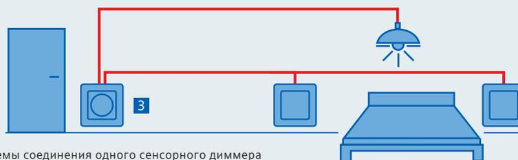
Вариант схемы соединения одного сенсорного диммера с несколькими обычными клавишными выключателями
