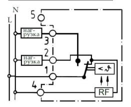
Клемма 1-2: Обогрев AC 250B 16 (4)A Клемма 1-3: Охлаждение AC 250B 5 (2)A
