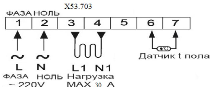
**ВНИМАНИЕ!** НЕПРАВИЛЬНОЕ ПОДКЛЮЧЕНИЕ МОЖЕТ ПРИВЕСТИ К ВЫХОДУ ИЗ СТРОЯ ТЕРМОРЕГУЛЯТОРА, ДАТЧИКА ТЕМПЕРАТУРЫ, НАГРЕВАТЕЛЬНОЙ СЕКЦИИ. ПОЛЬЗУЙТЕСЬ УСЛУГАМИ КВАЛИФИЦИРОВАННЫХ СПЕЦИАЛИСТОВ.
